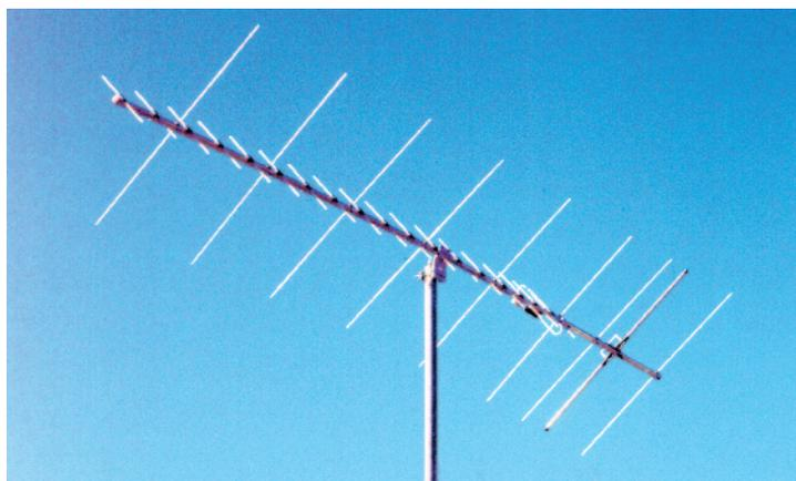
Antenne mixte, constituée d'une antenne 9 éléments montée perpendiculairement à une antenne 19 éléments, sur le même corps. Ce modèle est spécialement étudié pour les installations modestes de trafic via satellite.
