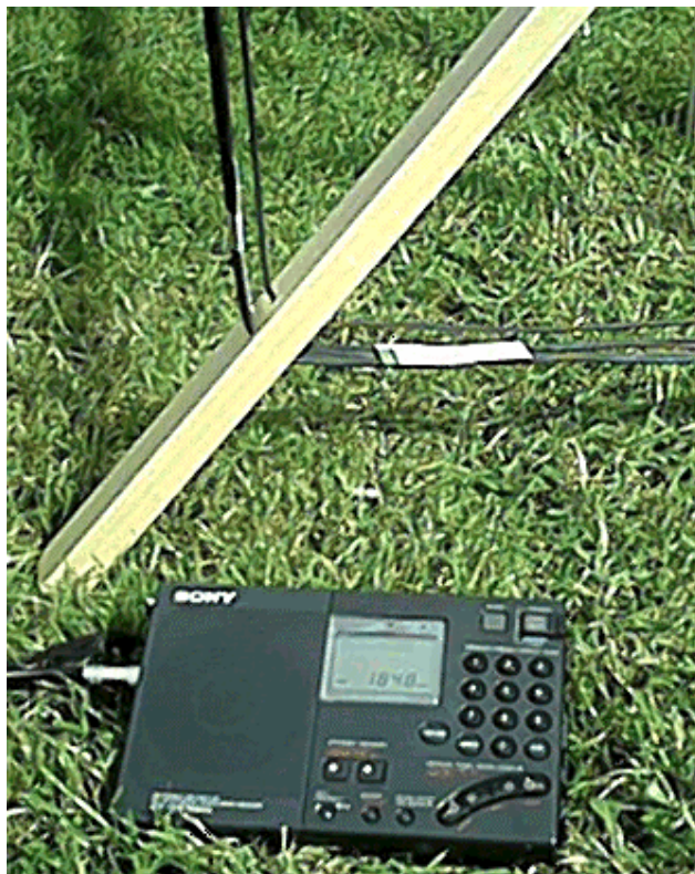
détail sur les spires primaires et la spire secondaire. Des morceaux de carton ont été scotchés pour bien maintenir les cinq spires du circuit primaire sur un même plan.
