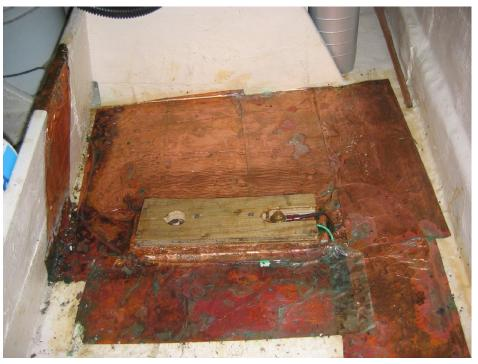
J'ai ajouté quelques rangées de ruban de cuivre au dessus de la Dynaplate pour faire un bon contact capacitif.
