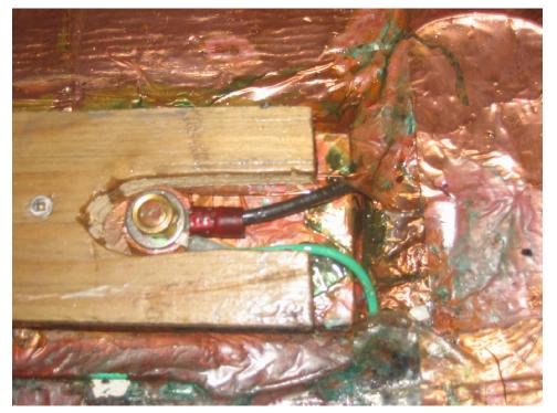
Remarquez les connexions électriques de la Dynaplate. Le fil noir est raccordé directement à la mise à la terre de l'accordeur d'antenne et le fil vert est raccordé à la mise à la terre du réservoir de diesel. J'ai installé une autre plaque pour protéger les connexions au dessus de la plaque de montage.
